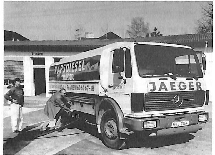
Dieter Jaeger (r.) hat seine Tankzüge so umgerüstet, daß der Motor während des Tankvorgangs abgeschaltet werden kann. Hier fließen gerade die ersten Liter Biodiesel in den Tank von Alfons Gartner (l.). Foto: K. Kilger
