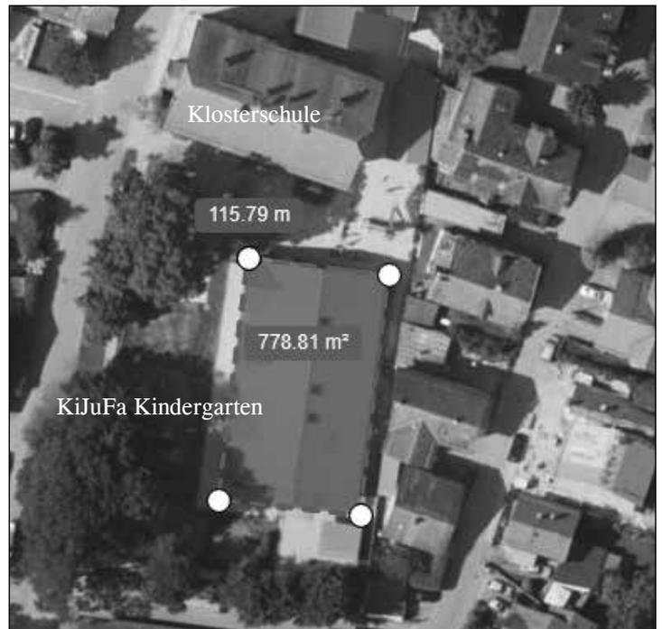
Mit einer Fläche von ca. 800 m<sup>2</sup> (deutlich größer als z.B. das Dach der Klosterschule) bietet sich das Dach des KiJuFa-Kindergartens für eine PV-Anlage geradezu an. Allerdings könnte sich, wie gut auf dem Bild zu sehen ist, der alte Baumbestand als problematisch erweisen.
